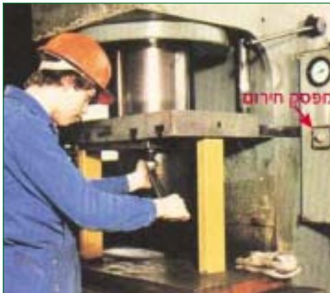
מפסק החירום מותקן במקום נגיש, ומספק לעובד הגנה לעבודה, תפעול וטיפול בטוחים בנוסף לאמצעי הגנה מכנייים
